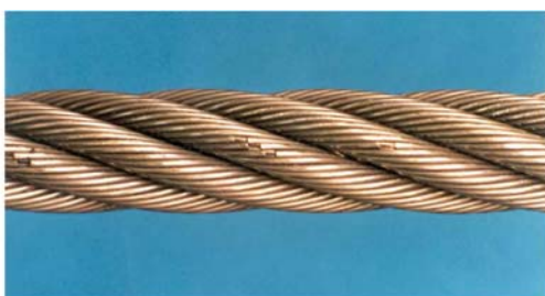
Fils cassés au niveau des « parures »
