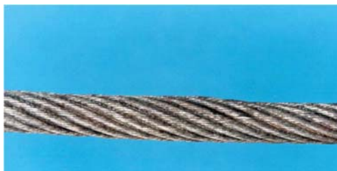
Augmentation locale du diamètre du câble due à l'extrusion de l'âme
