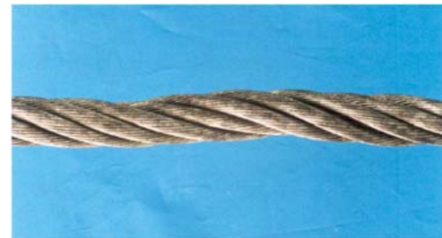
Diminution locale du diamètre du câble (torons creux)
