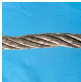
Diminution locale du diamètre du câble (toron creux)
