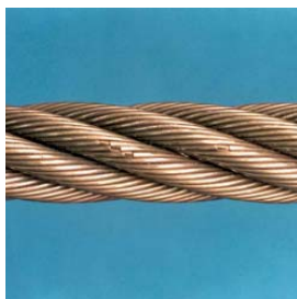
Fils cassés au niveau des «parures»
